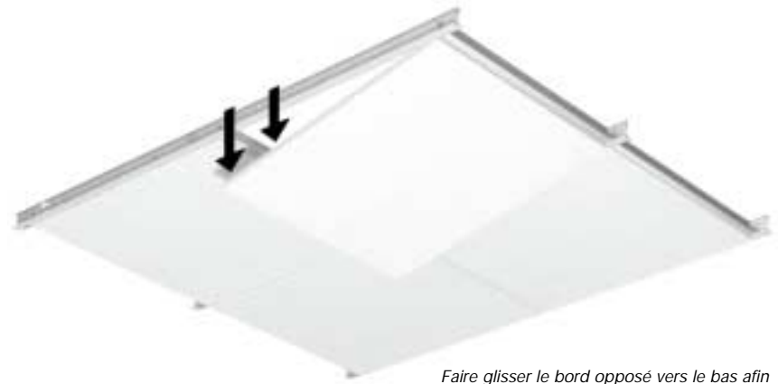
Faire glisser le bord opposé vers le bas afin de libérer entièrement la dalle de l'ossature.
