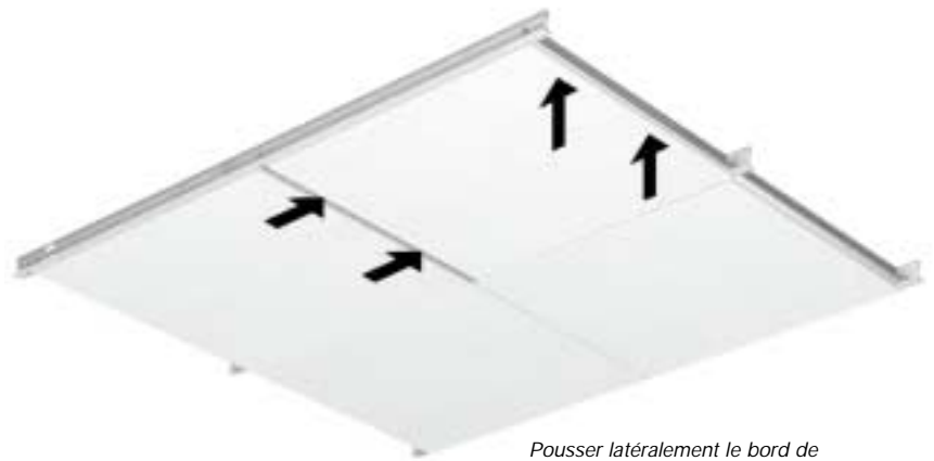
Pousser latéralement le bord de dégagement vers la dalle adjacente.
